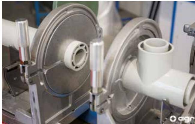
Die Abstandhalter im Rohr werden durchgehend extrudiert, so dass das Rohr beliebig gekürzt werden kann, ohne dass Abstandhalter zeitaufwändig manuell eingearbeitet werden müssen. Darüber hinaus verkürzt die Verbindungstechnik mittels simultaner Heizelement-Stumpfschweißung die Montagezeit von Poly-Flo zusätzlich.
